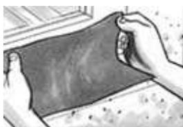
Posare la pellicola SikaMembran® Eco senza tensioni. Premere la pellicola nell'adesivo. In caso di sovrapposizioni, mantenere una lunghezza di sovrapposizione minima di 5 cm.
