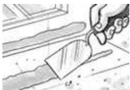
Con una spatola stendere la striscia di adesivo sull'elemento edilizio fino a ca. 4 – 5 cm di larghezza e 1 mm di spessore (secondo il sottofondo), all'elemento della finestra sono sufficienti una larghezza di 2 – 3 cm e uno spessore di 1 mm.
