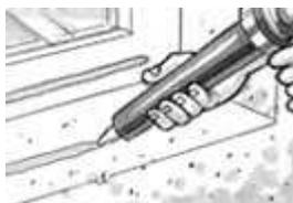
Applicare l'adesivo SikaBond® TF Plus N utilizzando la pistola ad estrusione (diametro dell'ugello ca. 8 mm).
