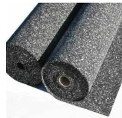
Lo strato di protezione Sarnafil è la protezione ideale contro i danneggiamenti meccanici dei manti Sarnafil T e Sarnafil PVC (soprattutto in presenza di carichi elevati, p.e. per coperture carrabili). Su coperture in Sarnafil PVC, per motivi di compatibilità, è richiesta la posa di uno strato di separazione, p.e. Sarnafelt T 300 oppure Sarnafelt VS 140.
