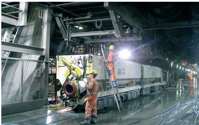
Fig. 3 RoCon-Shuttle beim Ladevorgang unter Tag (© Arge Transco). RoCon shuttle during loading underground (© consortium Transco).
