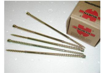
Questa vite con distanziatore, è stata concepita per Sistemi di copertura a tetto caldo sopra le capriate con isolanti termici adeguati (p.e. Flumroc Nova). La vite si fissa nelle capriate con un angolo di posa di 30° attraverso le controlistellature perforate in precedenza. Uno **speciale rivestimento** consente un avvvitamento semplice e razionale. Le **alette fresanti** poste dietro le spirali di ancoraggio della vite evitano rotture o screpolature del legname.
