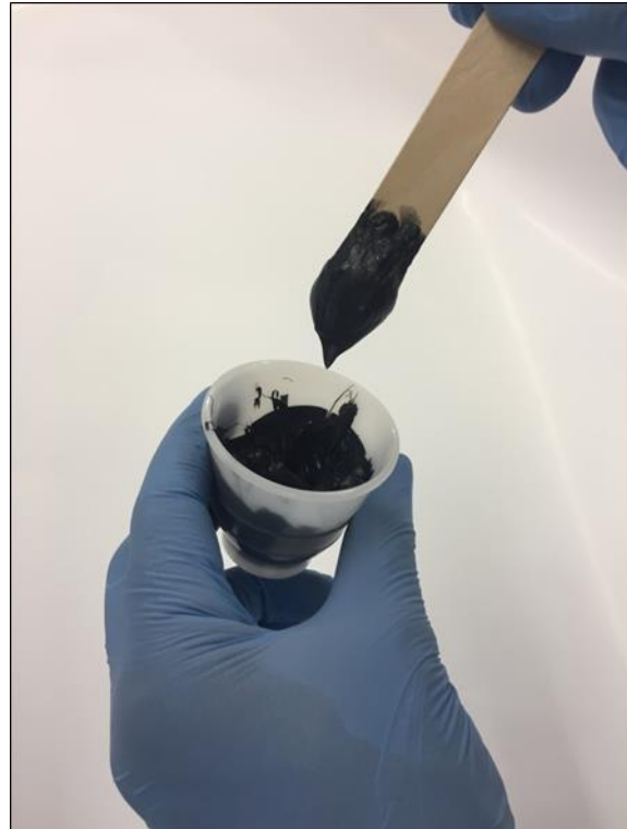
Figure 14 : le matériau présente un comportement caoutchouteux : la durée de vie en pot est atteinte.
