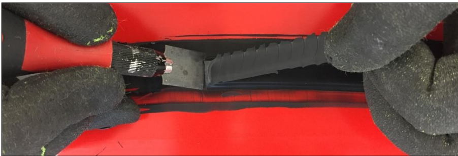
Figure 21 : test d'adhérence du cordon par pelage sur verre émaillé : le cordon est entaillé tout en tirant dessus.
