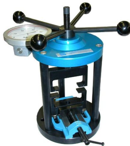
Banc d'essai manuel « Ban VEC » avec mesure numérique (distribué par GINGER CEBTP)
