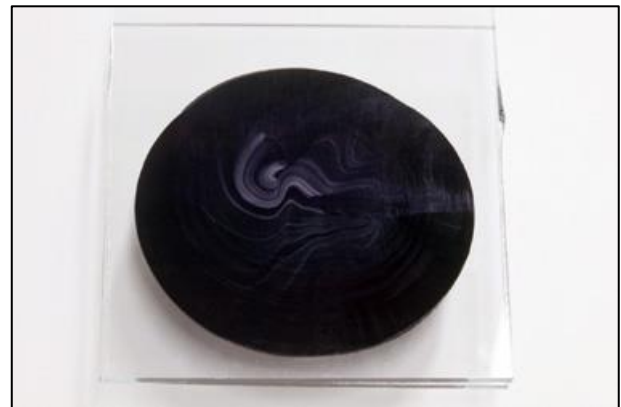
Figure 4 : test négatif = mélange insuffisant
