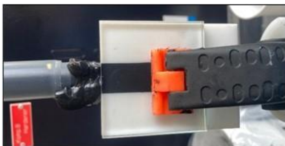
Figure 24 : remplir complètement les pièces en H de colle tout en évitant les bulles d'air
