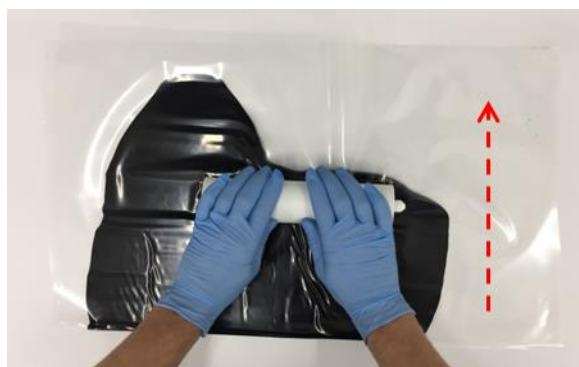
Figure 6 : presser le cordon perpendiculairement au pli
