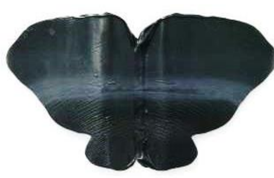
Figure 8 : test négatif = mélange insuffisant
