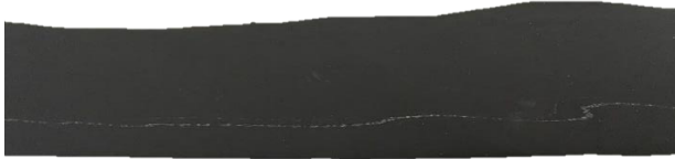
Figure 11 : stries blanches dans le matériau, mélange inhomogène
