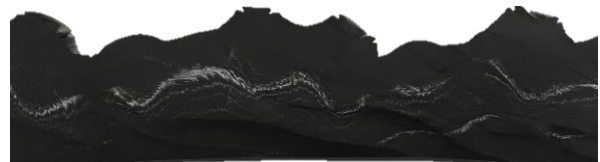
Figure 12 : stries blanches manifestes dans le matériau, mélange inhomogène
