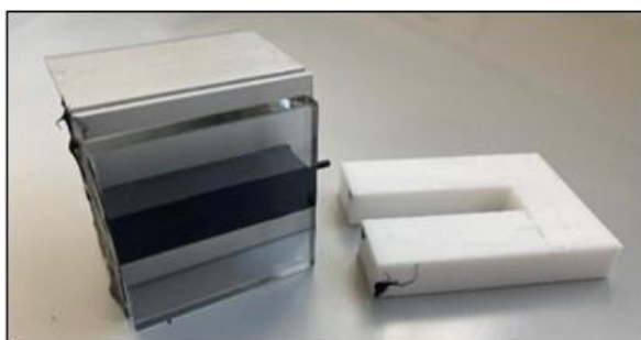
Figure 26 : enlever les espaceurs en U en téflon blanc après le temps de durcissement correspondant (voir ci-dessus).
