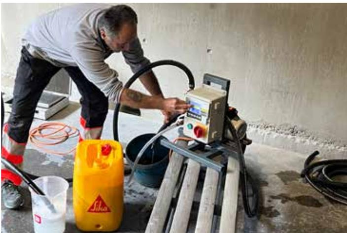
Sika Felddosiergerät DG13 mit programmierbarem Durchlaufzähler SMP, 230V.
