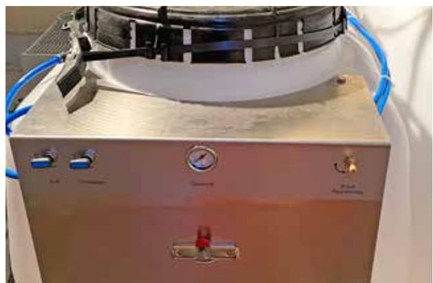
Frontbedienung: Die Umwälzanlage (Homogenisierungssystem) und die Feineinstellung der Pumpe werden über den Bestimmten Regler eingestellt. Das Moderne Design ist auf Augenhöhe montiert. Somit kann der Mitarbeiter jederzeit die Anlage ohne Leiter bedienen.
