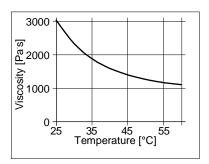
Diagramm 1: Viskosität in Abhängigkeit der Temperatur)
