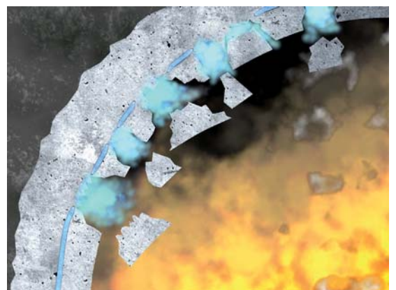
Bild 6. Der Dampfdruck in der Sättigungszone übersteigt die innere Festigkeit des Betons. Es kommt zu Abplatzungen (Quelle: Sika).
