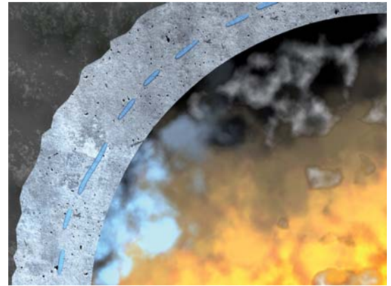
Bild 4. Der Dampf füllt die Poren und entweicht über die beflamnte Seite (Quelle: Sika).
