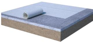
Dérouler le SikaProof®-810 (horizontal) ou le SikaProof®-808 (vertical) puis coller les chevauchements avec le SikaProof® Tape-120 ou le ruban adhésif double face SikaProof® Sandwich Tape. Égaliser toutes les zones encollées au rouleau en exerçant une pression suffisante.
