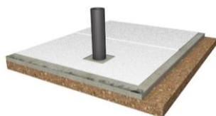
Découper un carré dans la membrane. Le trou doit être au moins 80 mm plus grand que le passage pour conduite, sur les quatre côtés.
