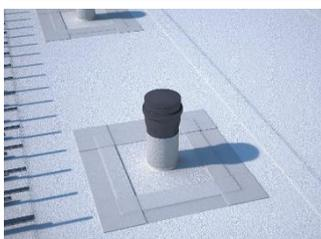
Utiliser un morceau de membrane qui chevauche la membrane de base d'au moins 50 mm.
