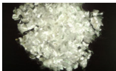
Nel calcestruzzo indurito le fibre in polipropilene fanno da ponte sulle fessure.
