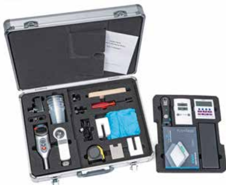
Laborset für die Qualitätskontrolle während der Anwendung von Sikasil® SG- und Sikasil® IG-Klebstoffen.
