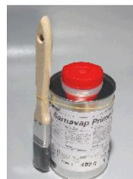
Le Sarnavap Primer 130 est un pré-enduit d'adhérence utilisé pour le Sarnatape, les bandes autocollantes Sarnavap et le Sarnavap Tape sur les surfaces poreuses ou absorbantes (bois, mur en brique, béton, etc). Une membrane protectrice en aluminium doit être percée avant l'utilisation.
