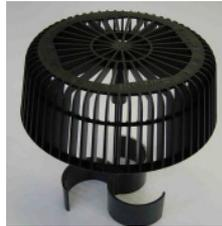
Les dégorgeoirs Sarnafil T sont fabriqués avec du PP dur injecté. Ils présentent une grande résilience ainsi qu'une bonne stabilité dimensionnelle et aux UV. Ils ne peuvent être mis en œuvre que sur un système de toit T.
