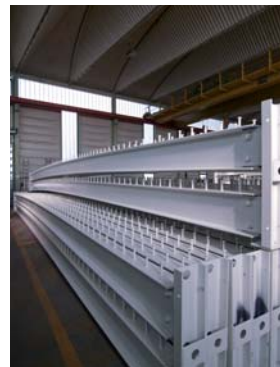
Die Stahlträger werden werkseitig in einem Arbeitsgang beschichtet.
