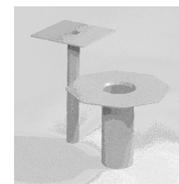
Le bocchette di scarico Sarnafil in PVC sono accessori "stampati per iniezione" in PVC rigido. Esse sono resistenti alle intemperie, ai raggi UV ed alla compressione e possono essere utilizzate solo con i Sistemi di coperture Sarnafil a base di PVC. Le bocchette di scarico 50, 56, 63, 75, 90, 110, 125 e 160 mm rispettano le regole tecniche DIN 19599 in collegamento con le norme EN 1253.
