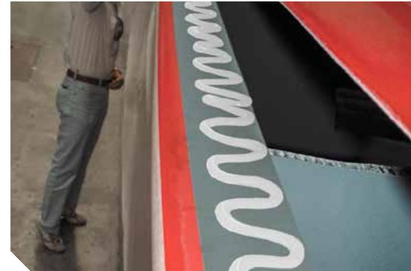
Sikaflex®-292i wird dickschichtig auf die Verbindungsfläche aufgetragen
