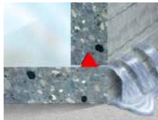
SikaSwell® S-2 beginnt bei Wasserkontakt zu quellen. Bis sich der Quelldruck aufgebaut hat, kann temporär eine geringe Wassermenge durch die Arbeitsfugen sickern.
