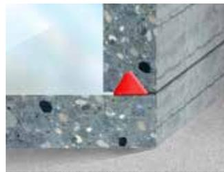
Durch den entstehenden Quelldruck presst sich SikaSwell® S-2 gegen den umgebenden Beton und garantiert dichte Arbeitsfugen.
