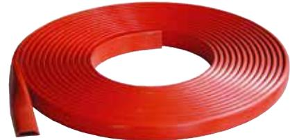
**SikaSwell® Profile sollten möglichst in der Mitte des Betonquerschnittes liegen. Stöße und Ecken werden stumpf ausgebildet.**
