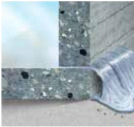
Ohne SikaSwell® Profile dringt Wasser durch die Arbeitsfugen. Dies führt zu undichten Bauwerken.
