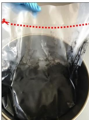
Bild 2: Vakuum versiegelter Innenbeutel
