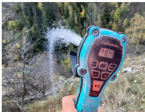
Fig. 10: vérification/contrôle du fonctionnement du dosage de l'eau
