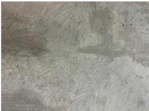
Fig. 38, 39: Grenailage d'une surface en BFUHP
