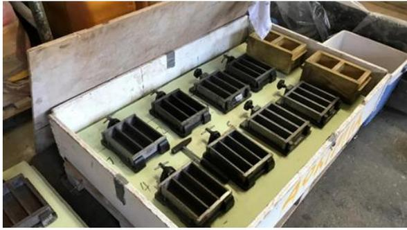
Fig. 13: coffrages cubiques et prismatiques
