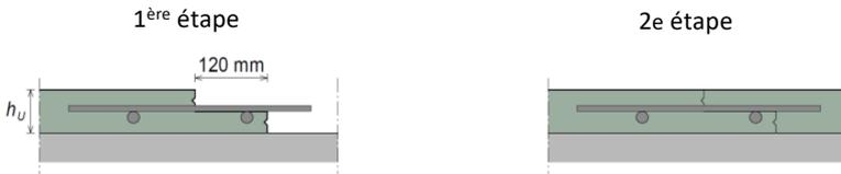
Fig. 35: détails constructifs pour la réalisation de joints de reprise dans le BFUHP (II)
