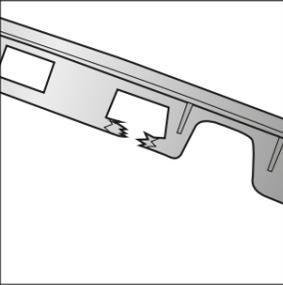
1 Der Schaden: ein beschädigtes Gewindeloch.
