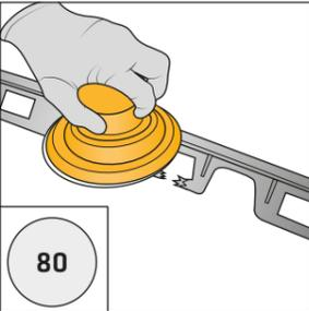
2 Die Kanten mit 80er Schleifpapier schleifen.
