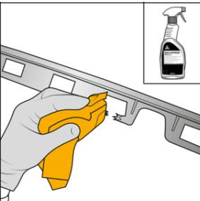
3 Den gesamten Arbeitsbereich mit Sika® Cleaner G+P, reinigen und sicherstellen, dass die Oberfläche vollständig trocken ist.
