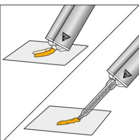
6 Vor dem Anbringen des Statkmischers, so lange Material auspressen, bis beide Komponenten A und B gleichmässig fließen.
