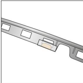
8 Das Klebeband darüber verpressen und warten, bis der Klebstoff gemäss den Angaben auf der Produktetikette aushärtet.
