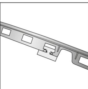
5 Klebeband hinter der zu reparierenden Stelle anbringen.
