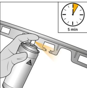
4 Eine dünne Schicht Kunststoffprimer auf beiden Seiten aufbringen. 5 Minuten<sup>1)</sup> ablüften lassen.
