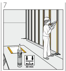
Appliquez un cordon triangulaire de colle SikaTack® Panel à l'aide de la buse triangulaire fournie (largeur 8 mm, hauteur 10 mm). Distance minimale de 5 mm entre le ruban de montage et le tasseau.
