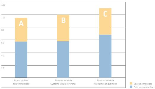
**Colonne A:** Panneaux composites en aluminium, fixés de manière visible par des rivets: Coûts totaux divisés en coûts de matériaux et d'assemblage.
