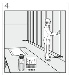
Activez les surfaces à coller avec Sika® Aktivator-205 et essuyez-les dans un sens avec un papier non pelucheux ou un chiffon de nettoyage (les chiffons sales doivent être remplacés).
