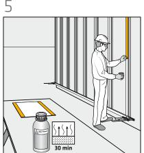
Secouez énergiquement le SikaTack® Panel Primer (le mouvement de la bille d'acier à l'intérieur doit être clairement audible). Appliquez une couche fine et uniforme de SikaTack® Panel Primer à l'aide d'un applicateur en mousse.
