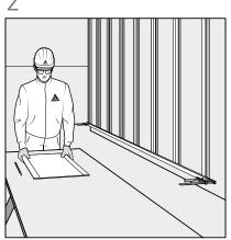
La surface à coller doit être propre, sèche et exempte d'huile et de graisse. Rendre le panneau et la structure du support rugueux avec un papier de verre (grain 80), selon la recommandation en fonction du système
