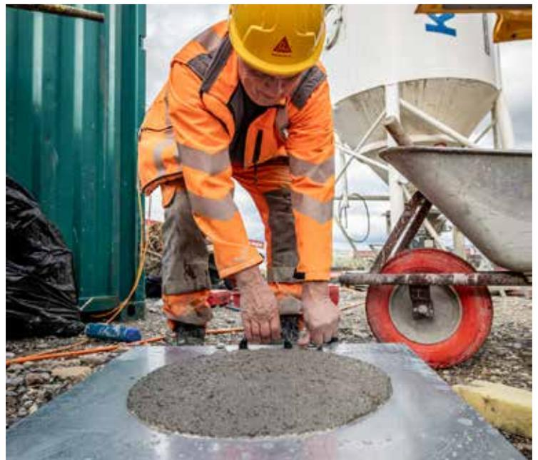
wurden vom Materialprüflabor der Sika Schweiz AG (Sika Betonservice) durchgeführt. Im Ergebnis erfüllten sämtliche fünf geprüften Spritzbetonsorten die Anforderungen und standen damit für den Einsatz in der Praxis zur Verfügung. Mit diesem positiven Ergebnis leistete Sika tatkräftige Unterstützung für die Ghelma AG Spezialtiefbau, die mit den Betonspritzarbeiten beauftragt war.
