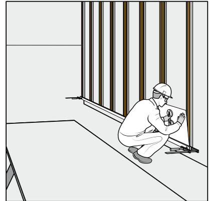
Platzieren des Panels an der gewünschten Position ohne dass das Panel das Montageband berührt. Danach fest auf das SikaTack® Panel Montageband drücken.
