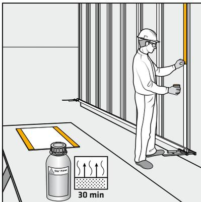
SikaTack® Panel Primer gut schütteln (die Bewegung der Stahlkugel im Innern muss gut hörbar sein). Aufbringen einer dünnen, gleichmässigen Schicht SikaTack® Panel Primer mittels Schaumstoffapplikator.
