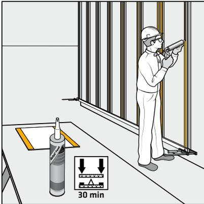
Auftragen einer Dreiecksraupe SikaTack® Panel Klebstoff mittels mitgelieferter Dreieckdüse (Breite 8 mm, Höhe 10 mm). Mindestens 5 mm Abstand zwischen Montageband und Leiste.
