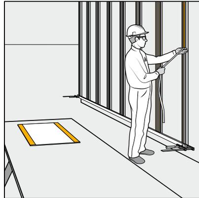
Entfernen der Schutzfolie auf dem SikaTack® Panel Montageband.
