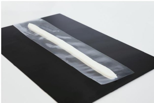
Bild 3: Klebstoffraupe auf halbe Höhe herunterdrücken
