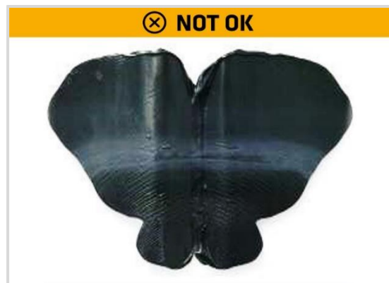
BILD 12 Folie auffalten - Negativer Test = unzureichende Mischung
