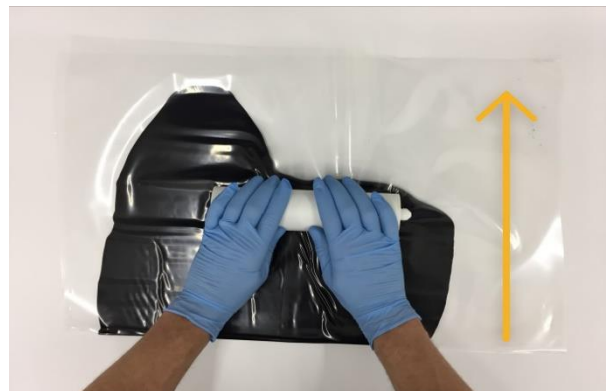
BILD 10 Die Klebstoffraupe nur rechtwinklig zum Falz beaufschlagen
