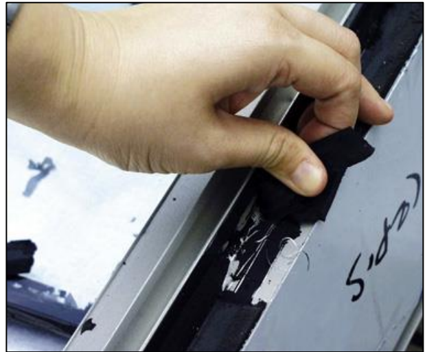
Bild 32: Klebstoffversagen, Entglasungstest nicht in Ordnung
