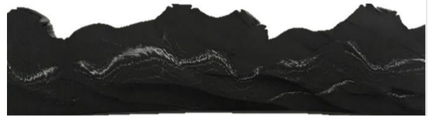
Bild 17: Deutliche weisse Streifen im Material, inhomogene Mischung
