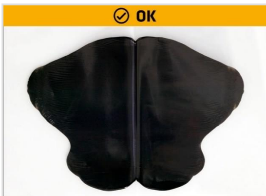
BILD 11 Folie auffalten - Positiver Test = ideale Mischung
