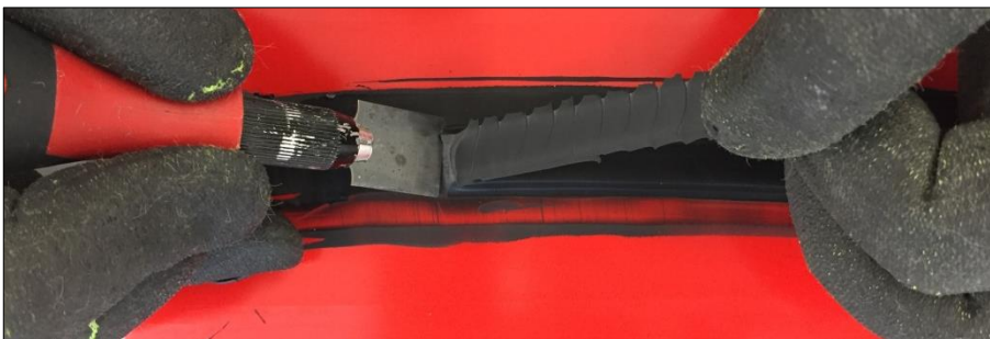
Bild 30: Raupenschältest auf emailliertem Glas: Raupe wird unter Spannung eingeschnitten.
