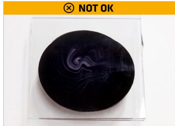
BILD 8 Negativer Test = unzureichende Mischung
