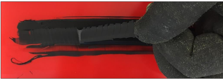
Bild 29: Raupenschältest: Ziehen der Raupe vom Untergrund, 100 % kohäsives Bruchbild.
