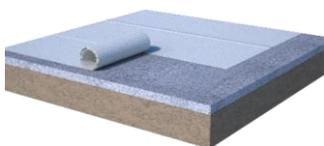
Srotolare SikaProof®-810 (orizzontalmente) o SikaProof®-808 (verticalmente) e incollare le sovrapposizioni con SikaProof® Tape-120 o con il nastro biadesivo SikaProof® Sandwich Tape. Rullare quindi le zone di adesione esercitando una pressione sufficiente.
