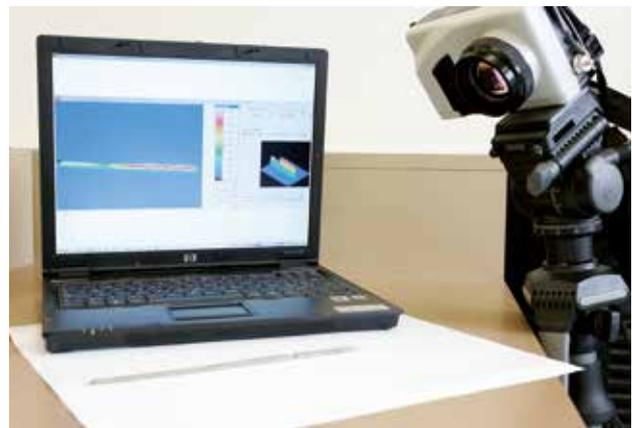
Sika System Engineering unterstützt die Optimierung der Klebstoffapplikation durch patentierte Testmethoden. Das obige Bild zeigt eine Infrarotkamera, die die Reaktionswärme von Klebstoffen misst.
