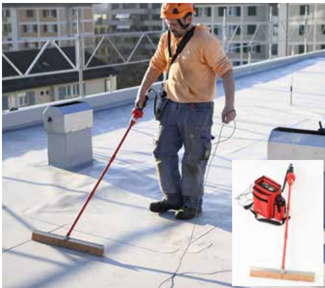
Controllo ad alto voltaggio: Il tetto deve essere ASCIUTTO e SENZA strato di protezione / di usura!
