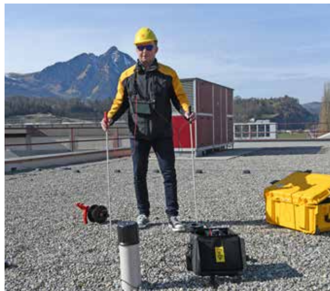
Controllo a basso voltaggio: Il tetto deve essere UMIDO/BAGNATO!
