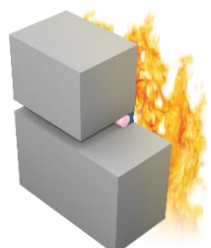
T3 Einzelfuge, feuerzugewandte Seite und jede Position innerhalb der Wand
