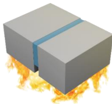
H Einzelfuge, horizontal, feuerabgewandte Seite
