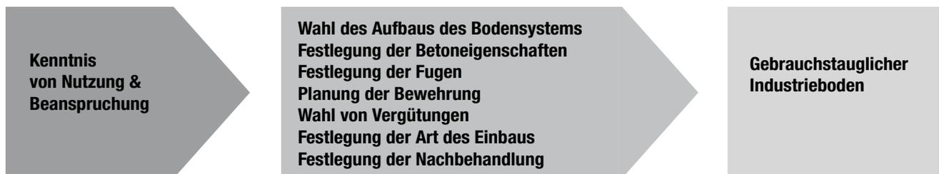
Die Wahl der Betoneigenschaften nach SN EN 206-1 hat einen direkten Einfluss auf die Betonzusammensetzung. Insbesondere da die Norm je nach Expositionsklassen minimale Zementgehalte und maximale W/Z –Werte vorgibt. Dies beeinflusst neben den Aspekten der Dauerhaftigkeit auch direkt die Druckfestigkeit und weitere Eigenschaften des Betons wie Verarbeitbarkeit und Offenzeit.
