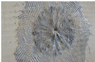
Wird diese nachträglich mit einem zementgebundenen Putz überarbeitet, muss der Harz mit Quarzsand abgestreut werden.
