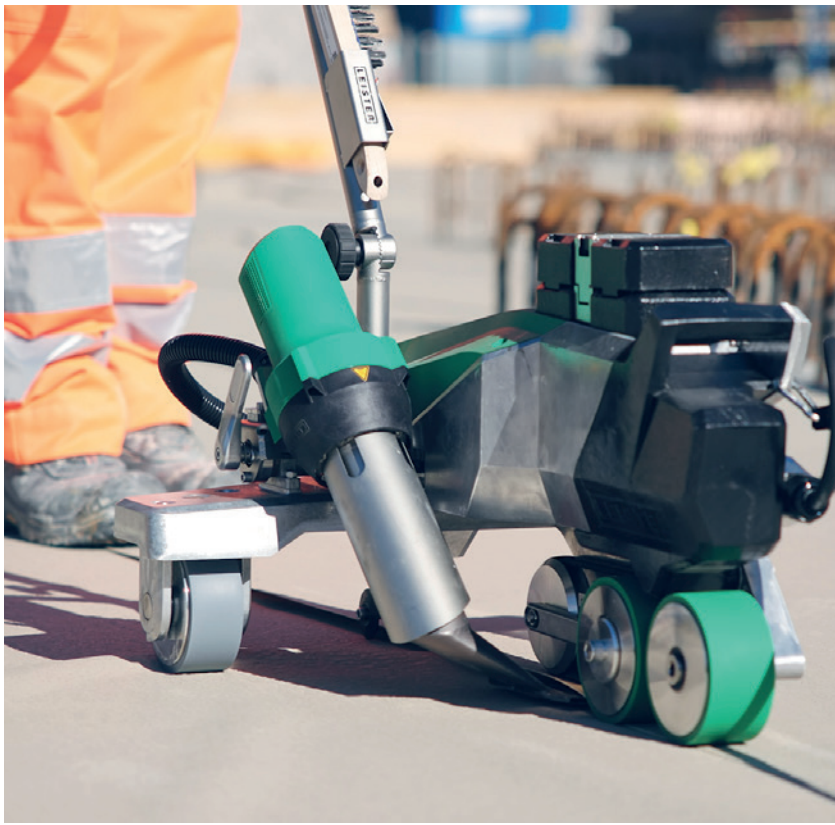
Der neue VARIMAT 500 garantiert Prozesssicherheit beim Verschweissen von Kunststoffdichtungsbahnen.
