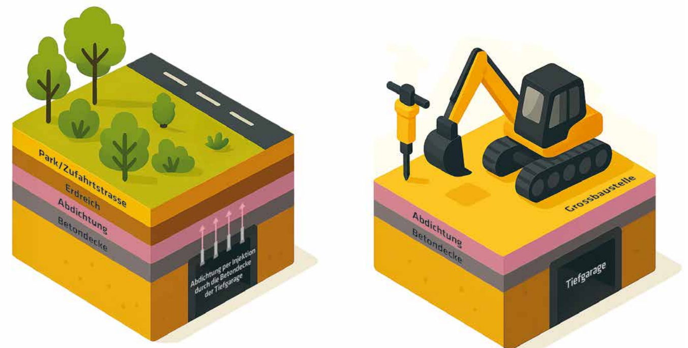
Wirtschaftliche Sanierung mit Schleierinjektion vs. Klassische Abdichtung von oben mit abgetragener Erde, Park und Strasse.
