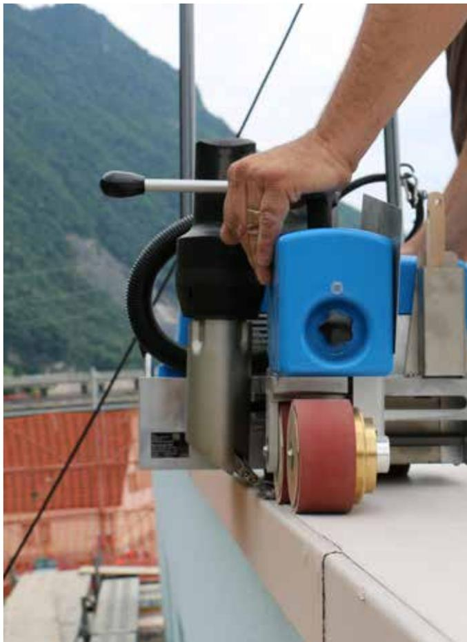
Verstellbare Lauf-/Andrückrollen ermöglichen das Schweißen uf dem Dachrand.
