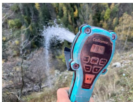
Fig. 10: verifica/controllo funzionale del dosaggio d'acqua.
