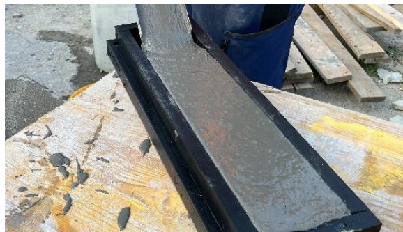
Fig. 14: colata di una trave per test di flessione
