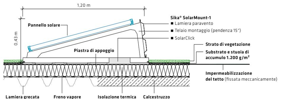
**STRATIGRAFIA TETTO VERDE\*:** Nella zona dell'impianto fotovoltaico l'inverdimento si posa tra le file di pannelli. Le parti di tetto situate sotto i pannelli restano liberamente esposte, per evitare in queste zone una crescita vegetale incontrollata e il relativo onere di manutenzione.
