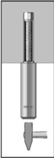
1. Konusbolzen mit leichten Hammerschlägen in den Porenbeton eintreiben bis der Bund des Setzwerkzeuges auf der Oberfläche aufliegt.
