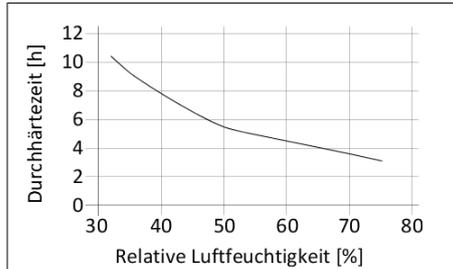
Diagramm 1: Durchhärtezeit für einen 500 µm Klebstofffilm
