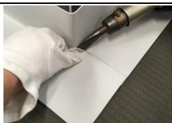
Saldare il lembo modellato lungo lo spigolo verticale.
