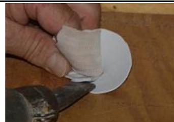
Scaldare l'angolo con il fon ad aria calda, premere con le dita e giuntare.
