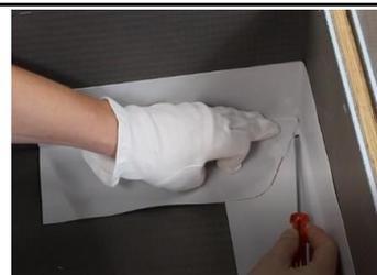
Una volta che il materiale è raffreddato, le attaccature (accessibili) possono essere controllate delicatamente con un cacciavite.
