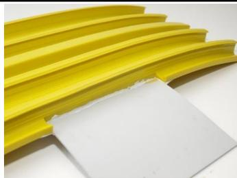
Incollare il nastro Sikadur-Combiflex® SG e il nastro Sika in PVC per giunti perimetrali tipo AF sull'intera superficie con SikaBond® AT-44R o Sikaflex®-11 FC+ (spessore dello strato: 1-3 mm). Ricoprire a spatola le aree di contatto dei due nastri con SikaBond® AT-44R o Sikaflex®-11 FC+. Spatolare le aree marginali del nastro Sikadur-Combiflex® sul lato superiore.
