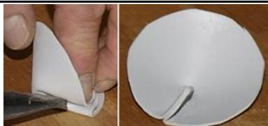
Scaldare la piega all'esterno del cono con il fon ad aria calda, premere con le dita e saldare.
