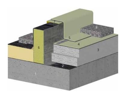
Durch die Montage eines Aufbordungsdetails mit Blechen und Wärmedämmung können unterschiedliche Abdichtungssysteme voneinander getrennt werden.
