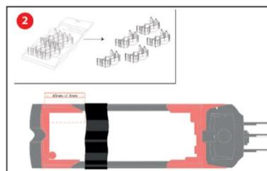
2 2 adaptateurs d'application sont nécessaires pour le grand distributeur. Positionner le premier adaptateur d'application sur le rail de guidage, mais ne pas encore le verrouiller.
