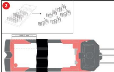
1 adaptateur d'application est nécessaire pour le petit distributeur. Positionner le premier adaptateur d'application sur le rail de guidage, mais ne pas encore le verrouiller.
