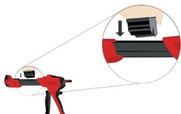
L'adaptateur d'application est solidement fixé aux rails de guidage des deux côtés du dispenser et supporte la cartouche à deux chambres prévue lors de l'extraction.
