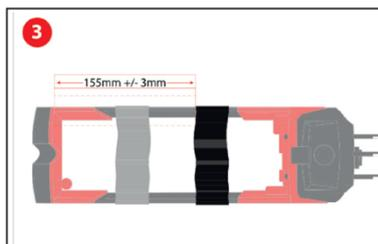
3 Positionner le deuxième adaptateur à 155 mm ( $\pm 3$  mm) du support au bord intérieur de l'adaptateur et appliquer une pression aux deux extrémités jusqu'à ce qu'il se mette en place avec un clic.
