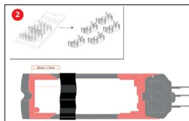
Per il dispenser grande sono necessari due adattatori. Appoggiare il primo adattatore sulle guide, ma senza incastrarlo.
