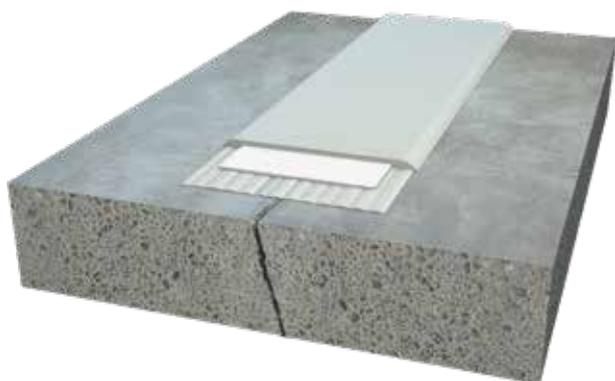
Pour les joints de reprise ou les fissures fines, la bande Sikadur Combiflex® SG est surcouchée complètement avec la colle Sikadur® Adhésif à base de résine époxy. En fonction des exigences, la colle peut être lissée, saupoudrée de sable de quartz ou revêtue. Les fissures de > 1 mm doivent être traitées comme les joints de dilatation.
