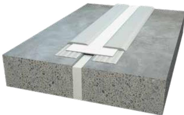
Pour les joints de dilatation ou les grandes fissures, mettre en place la bande Sikadur-Combiflex® SG dans la zone de mouvement sans colle à base de résine époxy. La zone de la bande non collée est déterminante pour l'amplitude du mouvement. En cas de grands mouvements, former une boucle avec la bande lors de la pose.
