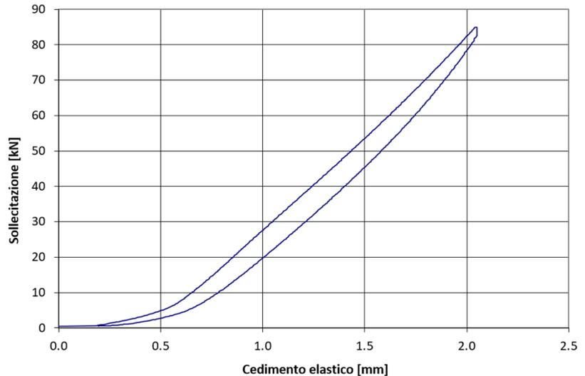
Curva caratteristica dell'elasticità calcolata in conformità alla norma DIN 45673-1.
