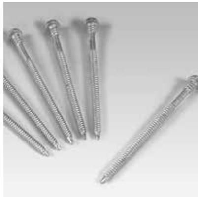
Der sechskant-Schraubenkopf ermöglicht eine optimierte Schraubsicherheit. Die Bohrspitze mit kleinem Durchmesser ergibt höchste Bohrleistung, insbesondere bei dicken Stahlblechen.
