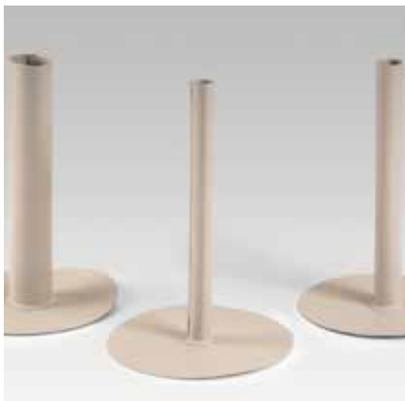
Die Pfosteneinfassungen gibt es offen oder geschlossen. Sie eignen sich zur sicheren Abdichtung von Pfosten mit einem Durchmesser von 23 bis 49 mm, haben eine Stützenlänge von 300 mm und ein Tablett von 210 mm Durchmesser.
