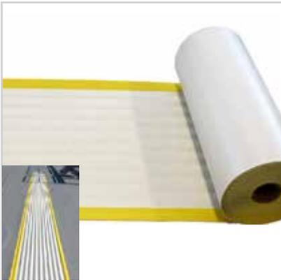
Die Sarnafil T Gehwegbahn ist auf der Basis von flexiblen Polyolefinen. Sie wird direkt auf die Abdichtung geschweisst. Mit der weissen Farbe und den gelben Markierungen an beiden Rändern ergibt sich ein optimaler Gehweg auf dem Nacktdach.
