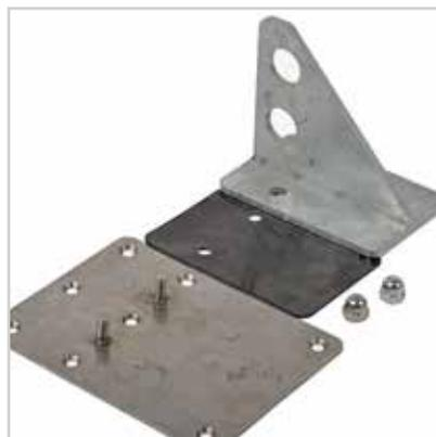
Geneigte Flachdächer benötigen einen Schneefang um das Abrutschen des Schnees zu verhindern. Die Edelstahlgrundplatte wird auf die Abdichtung montiert und mit dem vorgefertigten Sarnafil-Lappen verschweisst. Das Schwert aus verzinktem Edelstahl wird aufgeschraubt.
