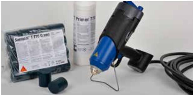
Sarnafil Spraytool 700 mit Sarnacol T770 GREEN - der lösemittelfreie Hot-Melt-Kleber sorgt für eine ökologische Verklebung, z.B. Sarnafil T auf EPS Wärmedämmplatten bei Aufborungen.
