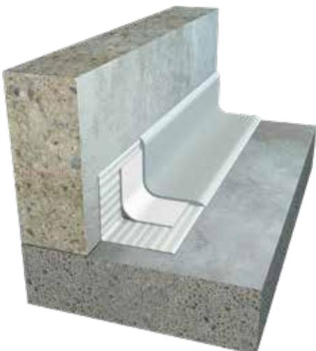
Es ist empfehlenswert die Boden-Wandanschlüsse innenseitig wie Hohlkehlen auszuführen. Der Sikadur® Epoxidharzklebstoff unter dem Band kann entsprechend ausgebildet werden. Beim Einbau als Negativabdichtung ist der Wasserdruck auf 0.5 bar limitiert.
