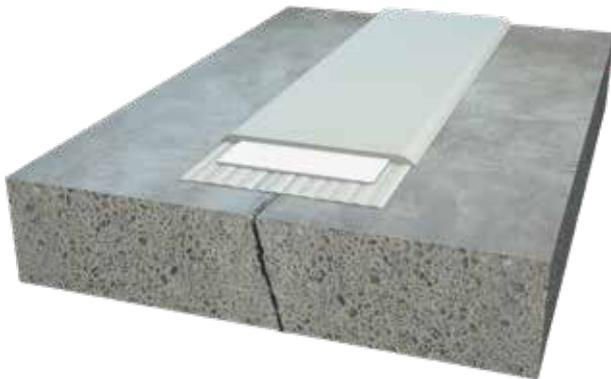
Bei Arbeitsfugen oder feinen Rissen wird das Sikadur-Combiflex® SG Band komplett mit Sikadur® Epoxidharzklebstoff überschichtet. Der Klebstoff kann, je nach Anforderung geglättet, abgesandet oder beschichtet werden. Risse > 1 mm sind wie Bewegungsfugen auszubilden.
