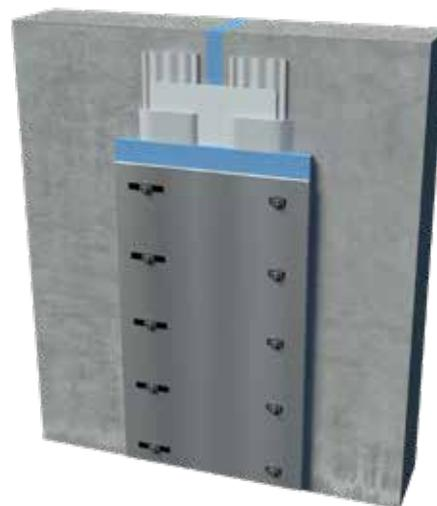
Bei Fugen, die negativem Wasserdruck über 0.5 bar ausgesetzt sind, muss das Sikadur-Combiflex® SG Band einseitig durch ein Stahlprofil gesichert werden.
