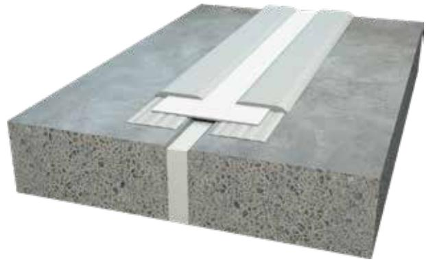
Bei Bewegungsfugen oder grösseren Rissen wird das Sikadur-Combiflex® SG Band in der Dehnungszone ohne Epoxidharzklebstoff eingebaut. Die unverklebte Bandzone ist für die Bewegungsaufnahme massgebend. Bei sehr hohen Bewegungen ist das Band schlaufenförmig zu verlegen.
