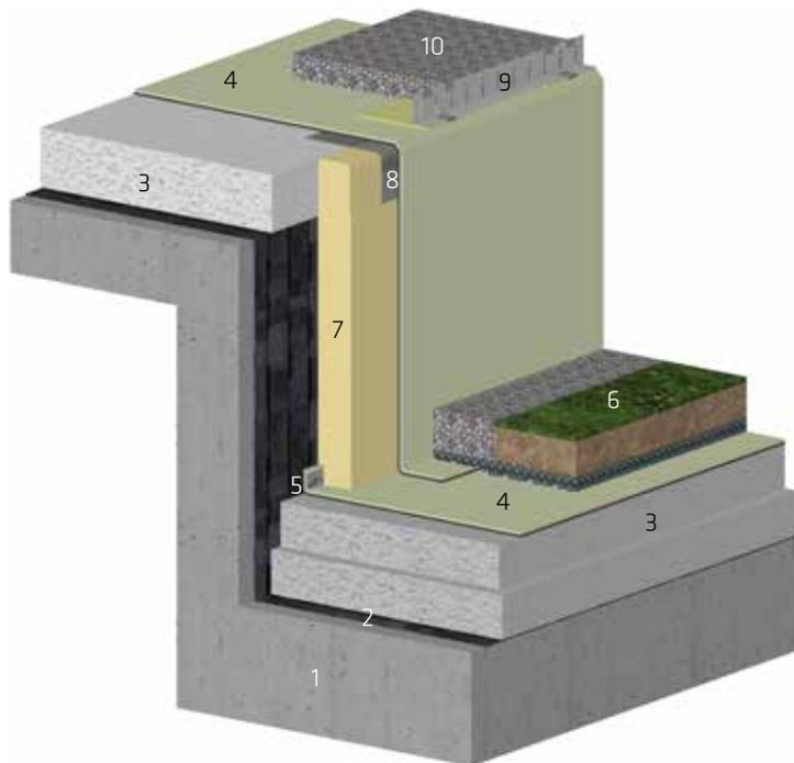
La tôle d'angle permet une pose stable et sûre surtout vers l'angle de la cage d'ascenseur.
