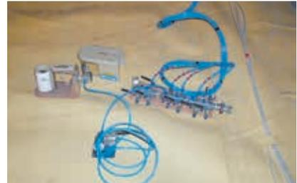
Beim Active Control System ist eine zusätzliche Leckerkennung im Abdichtungssystem auch während der Bauphase möglich. Mit der Vakuumprüfung lassen sich die doppellagigen Abdichtungsfelder jederzeit auf ihre Dichtigkeit hin überprüfen. Leckagen können genau erfasst und abgedichtet werden.
