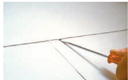
Alle handgeschweißten Nähte sollten nach vollständiger Abkühlung mechanisch getestet werden. Hierzu wird ein Schraubenzieher (etwa 5 mm breit, mit stumpfen Ecken) verwendet. Es wird ein leichter Druck auf die Schweissnaht ausgeübt. Dabei sollen Kratzer auf der Kunststoff-Dichtungsbahn vermieden werden. Mit dem mechanischen Test werden nicht vollständig verschweisste Stellen sichtbar und müssen nachträglich nachgebessert werden.
