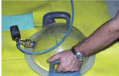
Bei der Vakuumprüfung wird eine durchsichtige Prüflocke auf die Naht- oder Stossverbindung aufgesetzt. Die Luft in der Glocke wird angesaugt, so dass ein Unterdruck entsteht.
