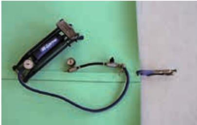
Doppelschweissnähte werden mit Druckluft auf ihre Dichtigkeit hin geprüft. Dabei wird der Prüfkanal an beiden Enden dicht verschlossen sowie ein Manometer mit Nadel angebracht. Mit einer Fuss- oder Handpumpe wird ein geeigneter Testdruck aufgebaut.
