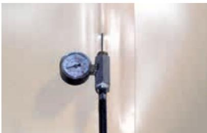
Standard-Testparameter für Druckluftprüfungen: Testdauer: 10 Minuten, Testdruck: 1.5 - 2 bar (je nach Temperatur und Produkt). Die Naht gilt als wasserdicht, wenn der Anfangsdruck im Prüfkanal während der Testdauer um maximal 10% abfällt. Die Druckwerte werden protokolliert, insbesondere Anfangs- und Enddruck.
