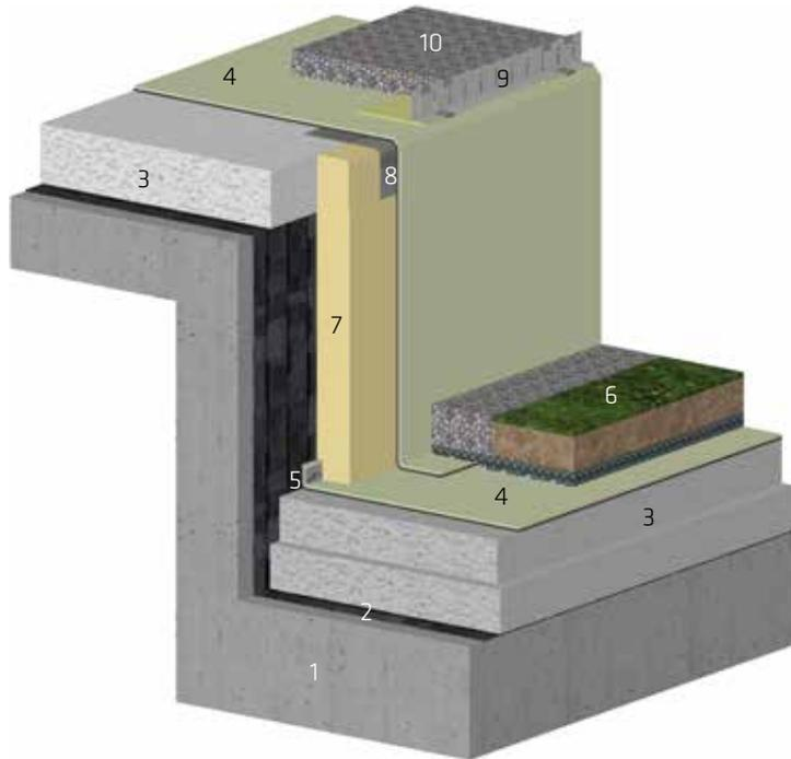
Das Kantenblech gewährleistet die Stabilität des Systemaufbaus auch im heiklen Bereich der Übergangskante.
