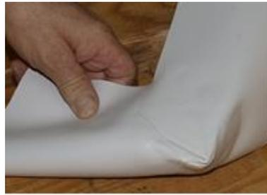
10. Una volta che il materiale è raffreddato, le attaccature possono essere controllate con un cacciavite.
