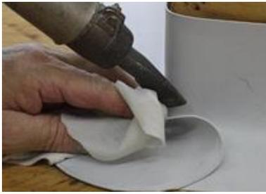
11. Fissare il disco puntualmente con il fon ad aria calda.
