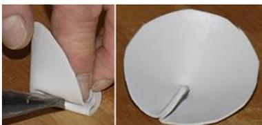
14. Scaldare la piega all'esterno del cono con il fon ad aria calda, premere con le dita e saldare.
