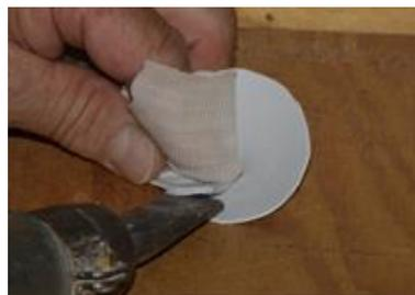
16. Scaldare l'angolo con il fon ad aria calda, premere con le dita e giuntare.
