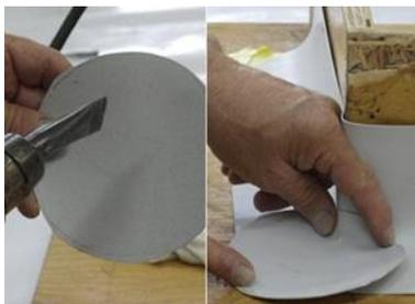
9. Scaldare il disco con il fon ad aria calda e modellarlo...
