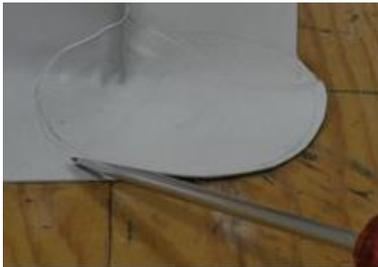
14. Una volta che il materiale è raffreddato, le attaccature possono essere controllate con un cacciavite.
